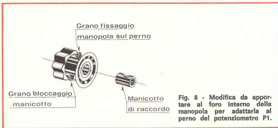
Fig. 8 - Modifica da apportare al foro interno della manopola per adattarla al perno del potenziometro P1.
