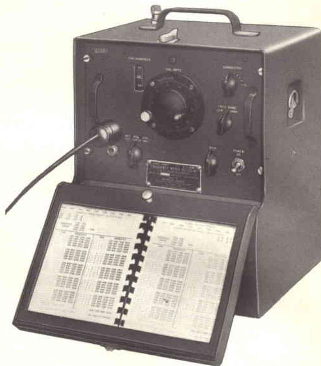
**I**l BC 221 è un ondametro ad eterodina, apparecchiatura di grandissimo interesse per una larga gamma di tecnici radio proprio perché si può affermare, senza tema di smentite, che è l'unico apparecchio di tipo professionale alla portata di ogni borsa.
