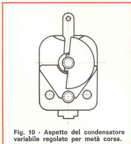
Fig. 10 - Aspetto del condensatore variabile regolato per metà corsa.
