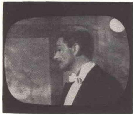
Fig. 1 - Immagine poco definita con sottofondo, dovuto a deficienza dell'impianto antenna-linea di alimentazione.
